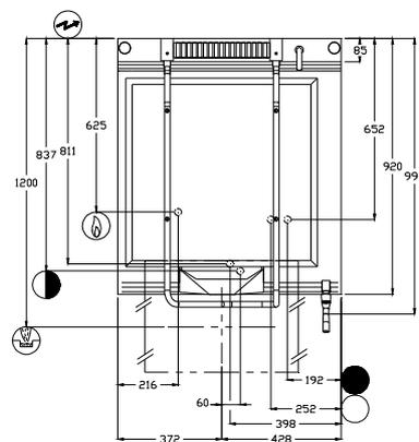
*La manœuvre de la poignée engendre un volume qui déborde du côté extérieur droit. Pour une ergonomie correcte, il est nécessaire d'avoir un minimum de 170mm de dégagement. En conséquence, il n'est pas possible de placer une sauteuse à **basculement manuel** à moins de 170mm d'une paroi.*
